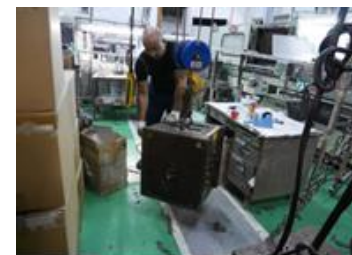
金型交換作業の様子
